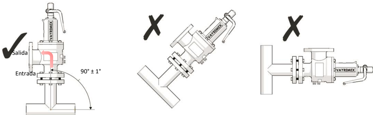
Fig. 6 Posición y orientación correcta de una VRP.
