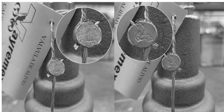
Fig.6 Estampado en los sellos de seguridad de plomo.
